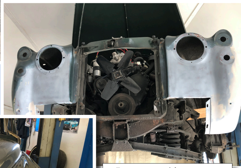
Fronten preparad för montering. Kylaren är iväg på renovering.
