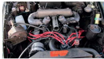
Rover 3,5-Litre (P5BB) motor. V8-an är mindre, lättare och har högre effekt.
