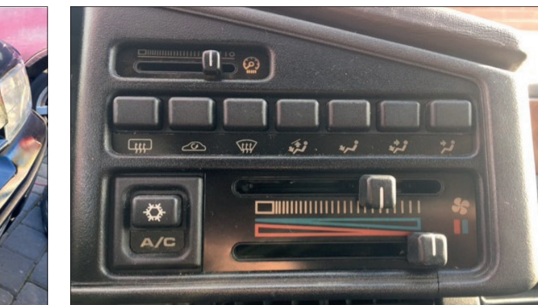
Ventilationsaggregaten är steglösa. AC-knappen fungerar så tillvida att den lyser...
