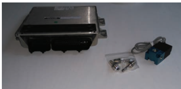
Till vänster: Bilens cpu. Till höger: En 3 port electronic solenoid boost control.
