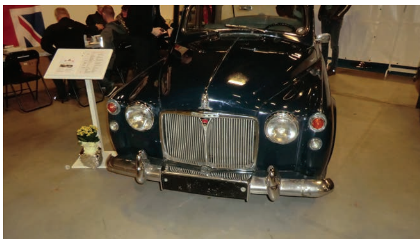
Rover 95 från 1963. Tillverkades i två år, totalt 3 680 stycken. Motorn är på 2 625 cc och ger 102 hkr och toppfarten närmar sig 150 km/tim
