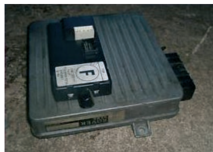
Styrenheterna är oavsett modell en aluminiumbox med kabelanslutning.
