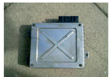
Styrenheterna är oavsett modell en aluminiumbox med kabelanslutning.
